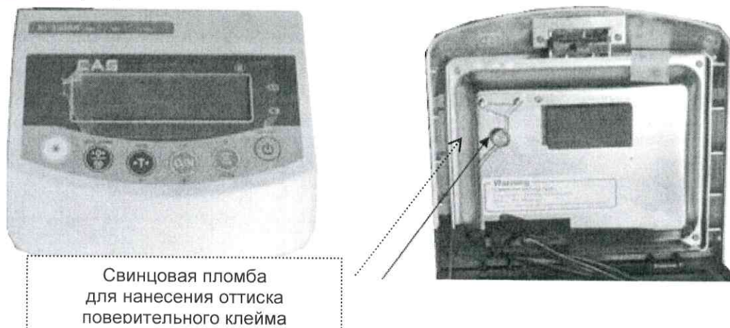
Рисунок А.1 – Схема пломбировки весов складских HFS, R, UFS (с использованием индикатора BI-100D, BI-100DB, BI-100R, BI-100RB)
