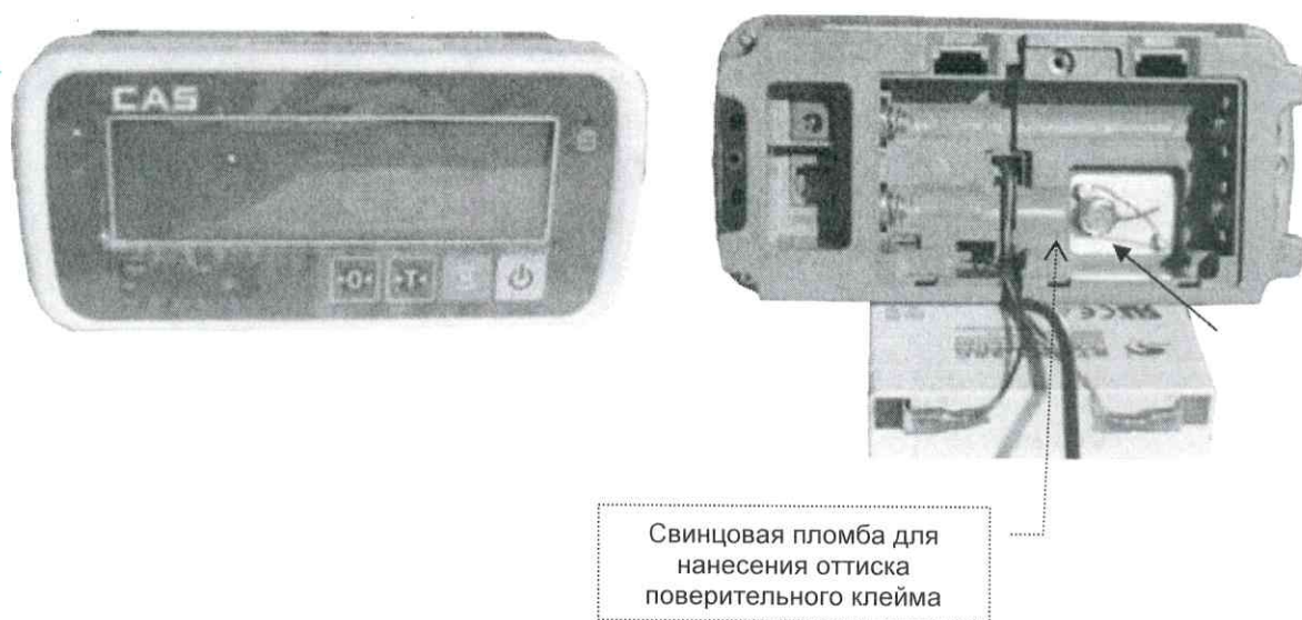
Рисунок А.4 – Схема пломбировки весов складских HFS, R, UFS, CPS (с использованием индикатора PDI)
