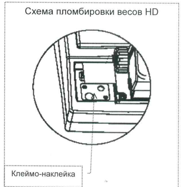
Рисунок А.3 – Схема пломбировки весов напольных BW, HD
