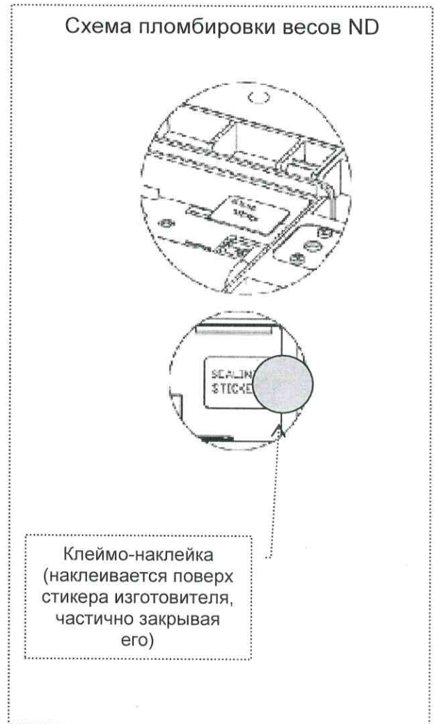
Рисунок А.2 – Схема пломбировки весов напольных DL, ND
